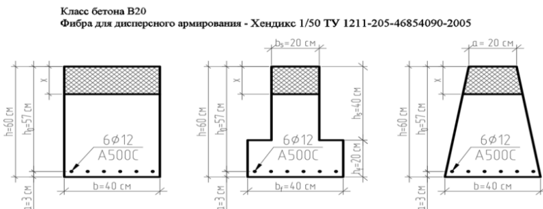
Рис. 1. Поперечные сечения железобетонных балок с дисперсным армированием и с одиночной ненапрягаемой арматурой
