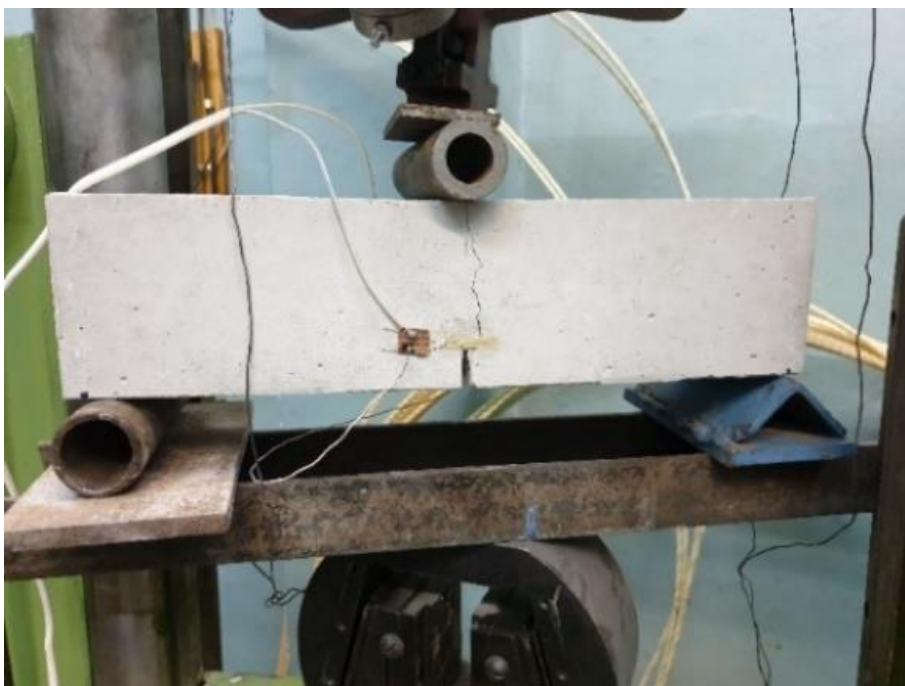
Рис. 3. Картина разрушения образца карбонатного бетона
