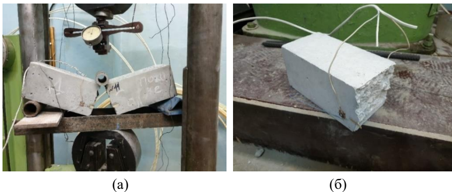
Рис. 4. Процесс разрушения контрольного образца карбонатного бетона (а) и одна из его половин с шероховатой развитой поверхностью после разрушения (б)
