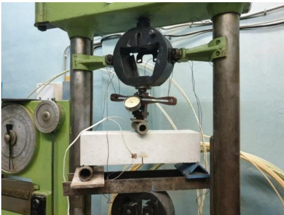
Рис. 1. Испытательное устройство с образцом и электрическим измерителем для определения мгновенных и длительных напряжений
